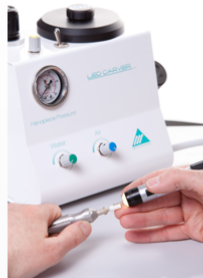
↳ Bearbeitung eines Zirkonabutments mit der Laborturbine LED Carver
